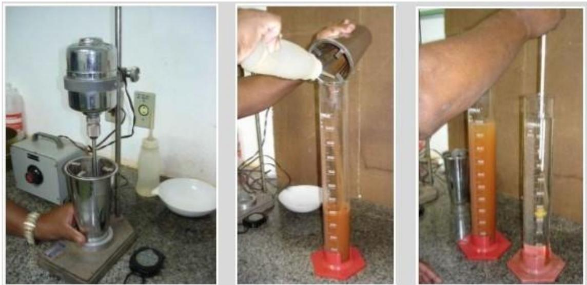
Aparato dispersor; Transferencia del suelo disperso a la probeta de 1 litro, y homogeneización de la temperatura del densímetro. Fuente: Obede B. Faria.
