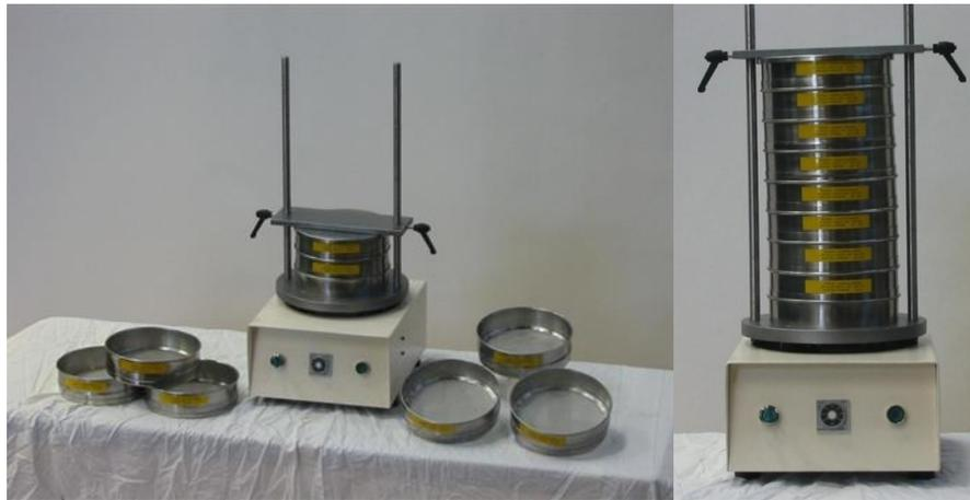
Foto 47 y Foto 48. Ensayo de tamizado: serie de tamices estandarizados y aparato eléctrico de tamizado. Fuente: Erimaki
